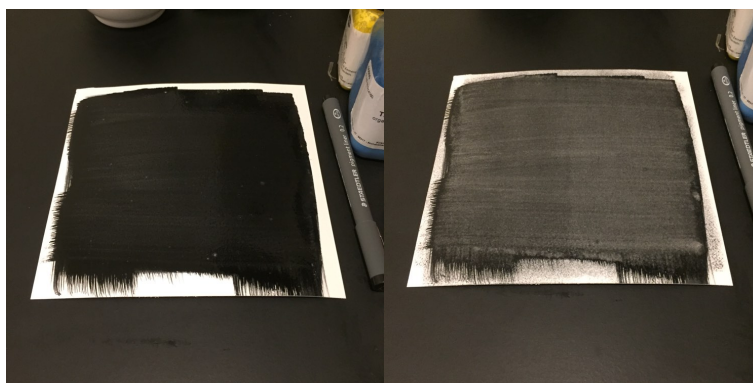
À gauche solution étendu au pinceau, à droite une fois tirée au rouleau
